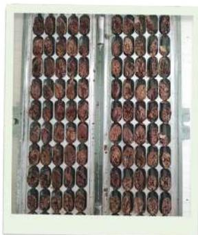
E. Guillotina para prueba de corte de grano de cacao
